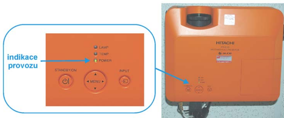
Obr. 3. Indikace provozních stavů na projektoru
