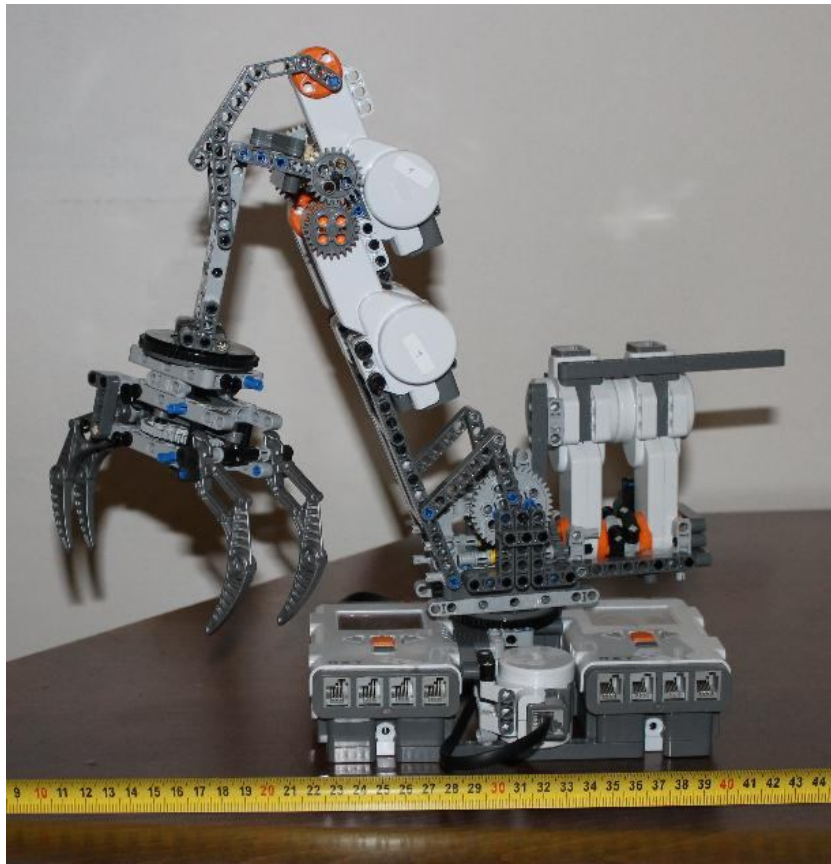
Obr. 5 – Model robotického manipulátoru
